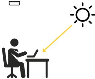
Con sufficiente luce naturale, la luce non si accende anche se viene rilevata presenza. Livello di luce settabile manualmente.
