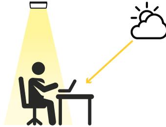
Con scarsa luce naturale, il sensore accende la luce quando viene rilevata presenza.
