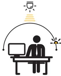
Con scarsa luce naturale, il sensore accende la luce quando viene rilevata presenza.
