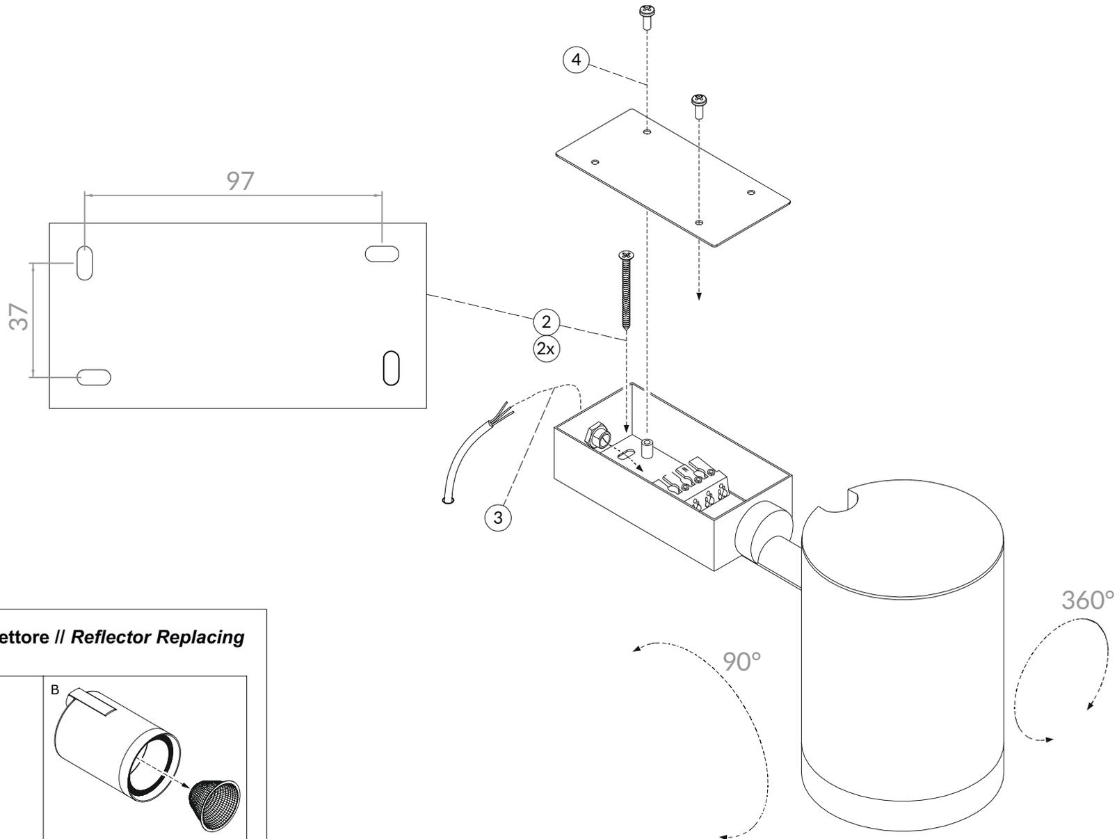
**// Sostituzione Riflettore // Reflector Replacing**
