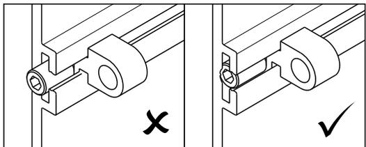
Operazione preliminare: eseguire prima del punto I 3. Eseguire su tutte le estremità da collegare. // This is preliminary: do this before point I 3. Carry out on every end to be jointed.
