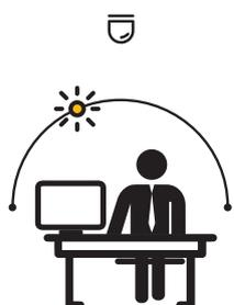
Con sufficiente luce naturale, la luce non si accende anche se viene rilevata presenza. Livello di luce settabile manualmente.
