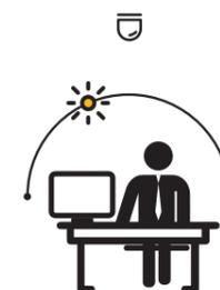
Con sufficiente luce naturale, la luce non si accende anche se viene rilevata presenza. Livello di luce settabile manualmente.
