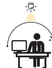
Con scarsa luce naturale, il sensore accende la luce quando viene rilevata presenza.
